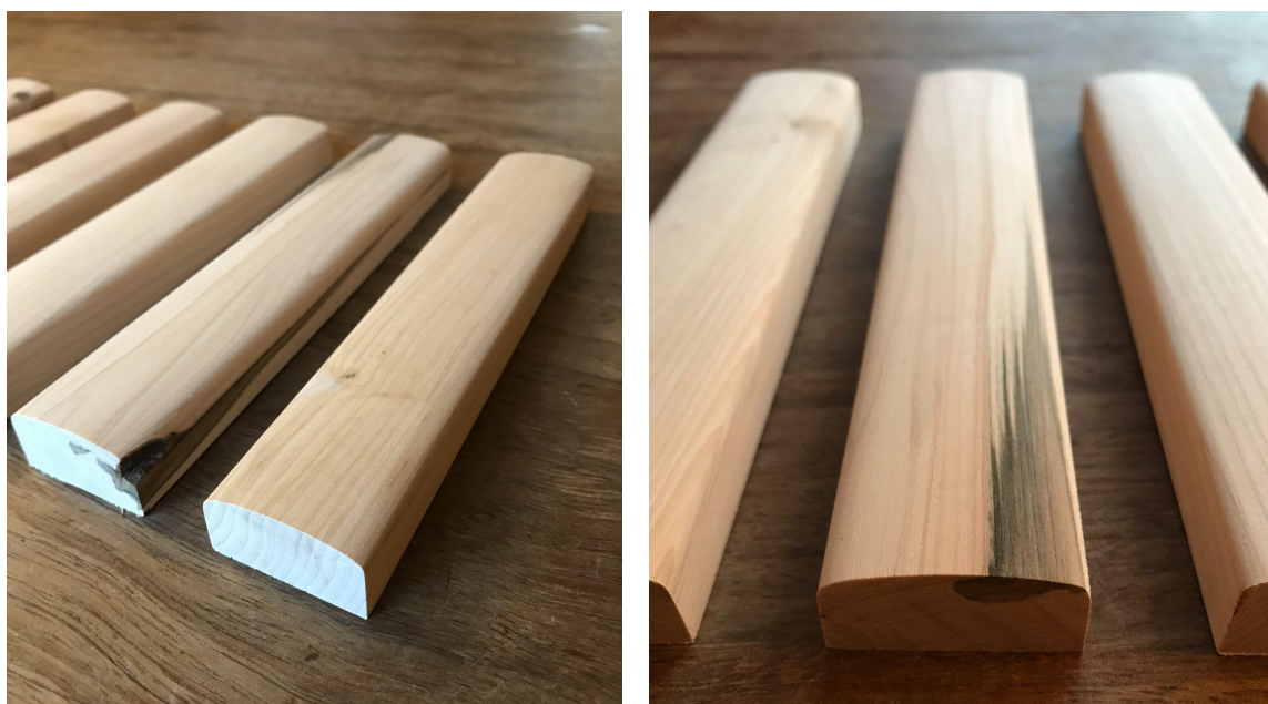
Provbit 2: Till vänster, hålighet på sidan av den andra ribban från höger. Till höger, blånad
